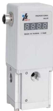
該比例閥為一個閉迴路設計，由兩個電磁閥、壓力傳感器以及電子迴路控制所組成。根據輸入訊號漸大，真空用電磁閥為開啟狀態，破真空用電磁閥為關閉狀態。因此，抽取真空壓力時透過真空用電磁閥作用於內部活塞，並致使與活塞連動的排氣閥打開，進而將大氣轉換成負壓，並通過壓力傳感器反饋至控制迴路。在此，該比例閥作動過程中會進行修正動作，直到真空壓力與輸入訊號成比例。
